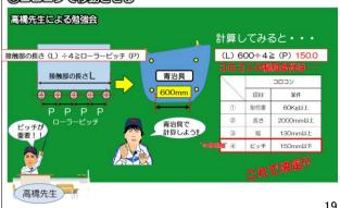
高橋先生から、コロコンは接触部の長さとローラーのピッチを間違えると 連搬中に荷が傾き、落下する危険がある事を教えて頂きました。 ローラーのピッチは、計算式を使って求められます。 私達の青治具に数字を当てはめますと150mmとなり、
