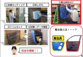
□ 対験の手順を 再度確認します。 手順は①設備のセッティングから ⑤データ確認まで 5つの工程に分類され 今回のテーマの決め手となった作業は ③青治具取付作業です。 青治具とはドアの内側の板金を模擬しています。
