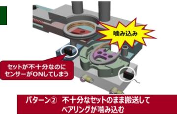
異常時の映像を確認すると、異常のパターンが2つあり、パターン①はベアリングのセットが不十分なのでセンサーがONせず、次の動作に行きません。パターン②はベアリングのセットが不十分なのにセンサーがONしてしまい、搬送してベアリングが噛み込んでしまいます。
