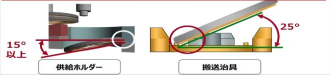
供給ホルダーの溝と、搬送治具着地面に引っかかり搬送治具にセットされない
