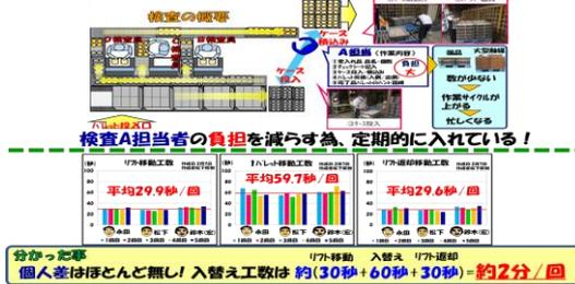
なぜ端品・大型触媒を定期的に最終検査に運搬しているか調査。最終検査は、検査員3人と投入・積込み担当の計4人で作業。数が少ない端品、大型触媒を連続投入するとA担当者の作業サイクルが上がり、負担がかかる為、入替えの多いパレットと絡め、負担を減らし、運搬しやすい列手前に移動しています。リフトは3交替で各直1名で対応。3人それぞれ、パレット入替え工数を5回ずつ測定。結果、個人差はほとんど無く、入替え工数は、1パレット当たり約2分です。
