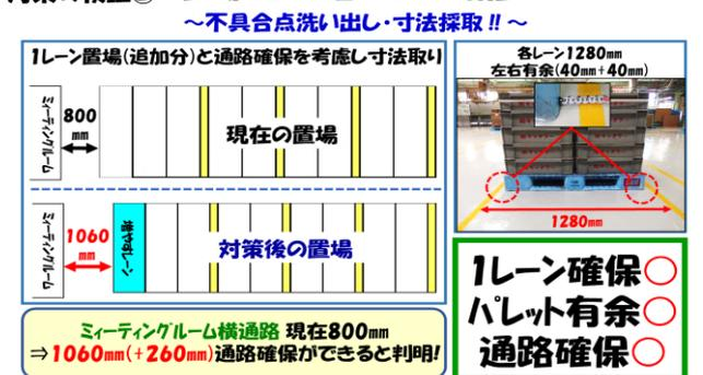
置場を1レーン増やす事を前提に、パレットを置いた際の左右の余裕と、ミーティングルーム横の通路確保を視野に入れ、寸法を出した結果、1060mm確保ができると判明。効果有りです。
