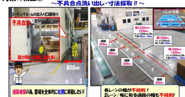
【仕掛品・検査待ち品置場を1レーン増やせるか】検証です。ミーティングルーム横入を、そのまま置場として使用すると、扉が開いた際に接触。通路も確保したい為、全体的に右側に移動した方が良さそうです。そこで、パレットの寸法を、全体的に置場全体を測定。各レーンと通路の幅が不規則である事が分かりました。
