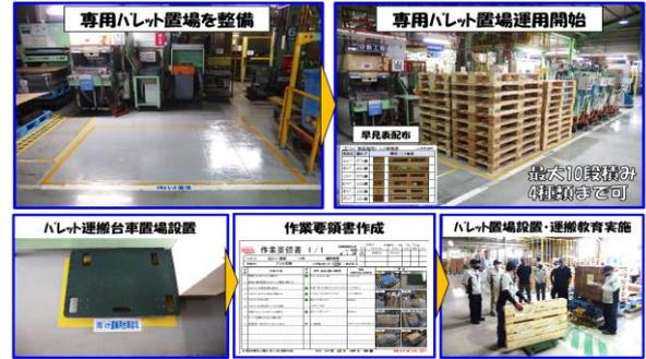
専用パレット置場の床面・ラインを塗装し整備。それに合わせ、ハレット運搬台車・早見表の設置、作業要領書を作成し標準化、作業者への教育を実施しました。
