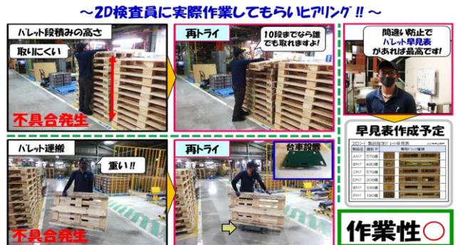
次に【2D検査員の作業性の調査】を実施。パレット段積みの高さを上限10段、パレット運搬は、台車を設置し使用、専用パレット早見表の設置。以上の対策で作業性はOです。
