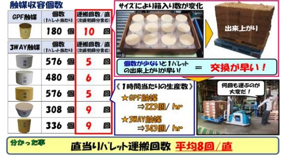
2Dコート製品の種類と収容個数・運搬回数を調査。製品は主に6種類あり、触媒のサイズにより箱入り数が変わります。入り数が少ないとハレトの出来上がりが早く、交換頻度が上がり、運搬回数も増加。直当たりのハレト運搬回数は、平均8回です。
