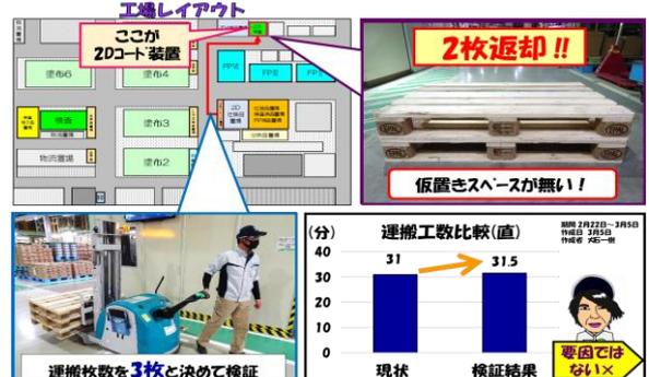
【運搬枚数が決まっていない】の検証です。専用パレット運搬枚数を3枚と決めて運搬。1枚は、検査員へ。残り2枚は、仮置きスペースが無く、専用パレット置場に返却する事になり、運搬工数が増加。要因ではありません。
