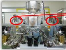
皮膜液チューブを、装置で挟み込み、皮膜を供給する
