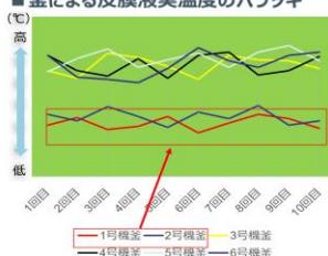
1・2号機釜、30・35kg仕込みの時の皮膜液温度が全体的に低い。
