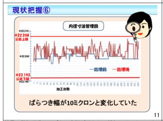
結果、熱処理後ではばらつき幅が明らかに増加し10ミクロンと なっていた。 これによりばらつき発生工程は熱処理工程となる。
