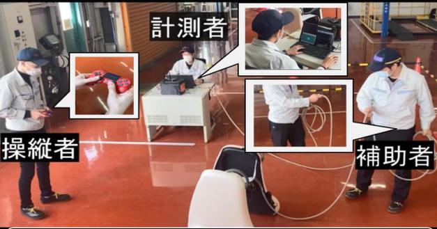
操縦：コントローラで操作 補助：配線サポート 計測：データ確認
