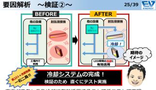
窒素ガスをLED冷却に有効活用することで低コストで実現。 まさに一石二鳥。 名付けて「窒素ガス冷却システム」の完成。 早速検証します。
