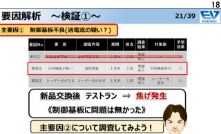
「主要因①制御基板不良」の検証。 <u>基板を新品に交換</u>しても、1ヶ月のテストランで焦げが発生。 基板が原因ではありませんでした。
