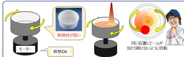
容器を動かす対策案の検討をメンバーとを行い、電子レンジみたいに回転させたいとの意見を採用。装置内で動かすために、小型のモーターを容器の下に置くことで回転できるようにしました。ビームの熱がモーターに影響しないように断熱を検討しますが、容器の断熱性があったおかげで、原料を動かしながらコートが実現しました。
