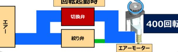
エア 切換弁 絞り弁 エアモーター 400回転
