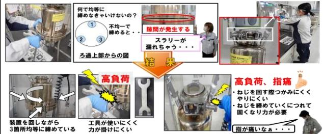
締め付け作業では、漏れ防止の為、レンチで装置の3点を均等に締め付けています。8kgの装置を動かしながら締める必要がありますが、**力が掛けにくい為、高負荷と判断。**フタのネジも回す際に掴みにくく、**指が痛くなる為、高負荷と判断しました。**
