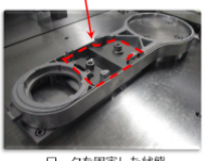
ワークを固定した状態
