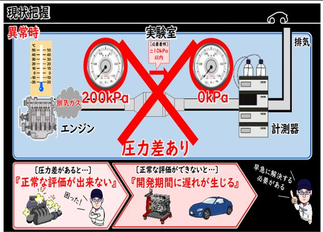
異常時は圧力計の値に差が発生、圧力差があると正常な評価ができず開発期間に遅れが生じるため早急に解決する必要があります。
