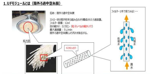
目の細かいストローク状の筒に廃水を通し、微細な汚れを除去。きれいな水にろ過して処理水として排出している。
